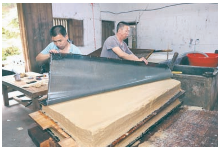
抄紙師傅配合默契地快速取出竹麻，轉身倒扣在木板上，輕輕揭起簾子，便分離出一張濕紙。
